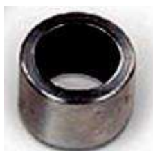
Bucșe presate sinterizate din HEA (a) și HEA/Gr (b)
