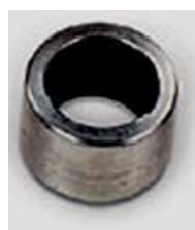
Bucșe presate sinterizate din HEA (a) și HEA/Gr (b)
