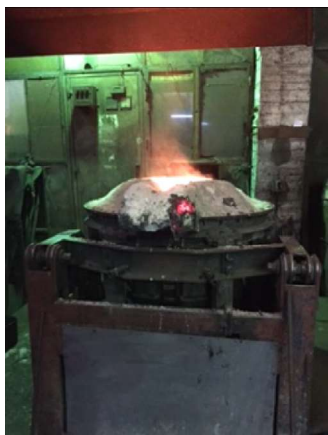
Cuptorul electric cu creuzet utilizat la Rancon Iași pentru elaborarea aliajelor HEA.
