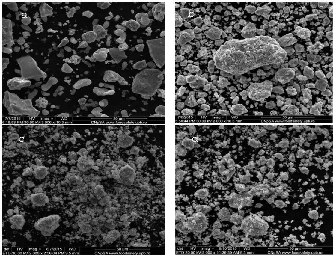
Figure 1. SEM image of AlCrFeMnNiGr HEA composite at (a) 0 h; (b) 20 h; (c) 25 h; (d) 40 h.
